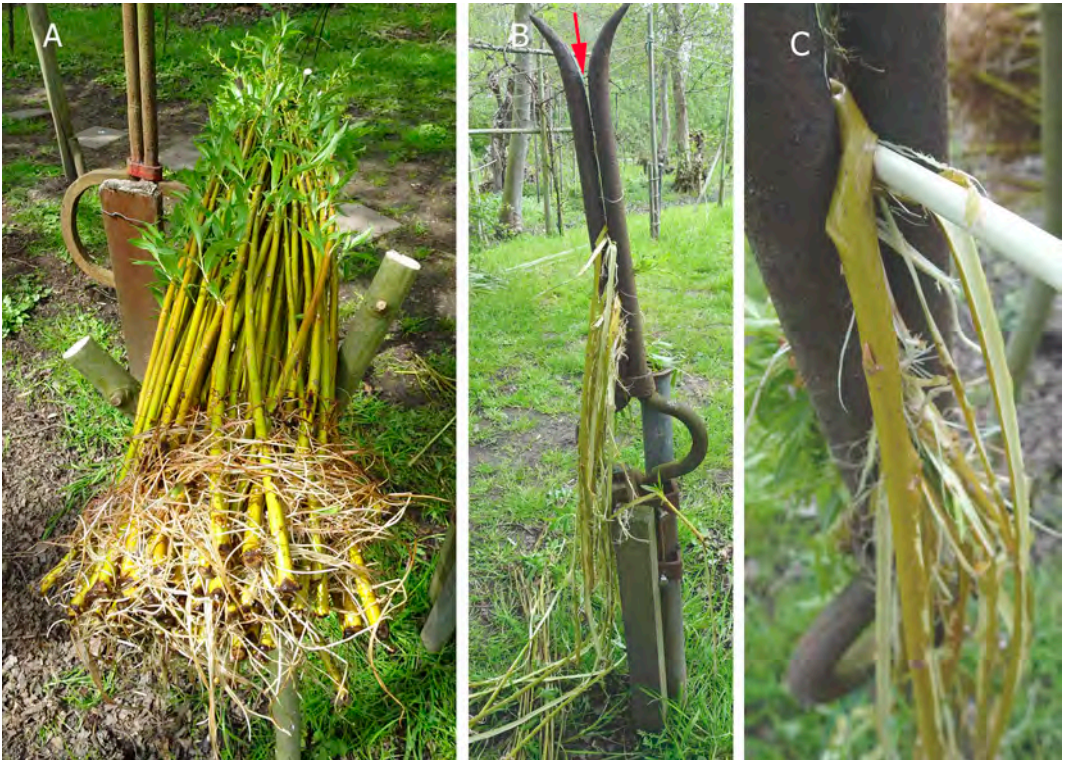
Afbeelding 5. Het schillen van teen die vanaf eind februari/ begin maart zo'n zeven weken in 10 cm water heeft gestaan. Na ongeveer zeven weken zijn uit deze tenen weer bladeren en wortels gegroeid (A). Deze tenen worden van boven in het schilijzer geslagen (rode pijl) waardoor ze daar in vastklemmen. (B) Dan de teen er horizontaal uit trekken waardoor de bast er in enkele stroken af getrokken wordt (C). Je houdt een witte teen over, de losgetrokken bast blijft in het schilijzer zitten. Die haal je er na enkele tenen uit. De witte teen wordt in de zon gedroogd en is zo een paar jaar houdbaar. Dit schillen is geen zwaar werk. Per uur kun je makkelijk 100 - 120 tenen schillen.
