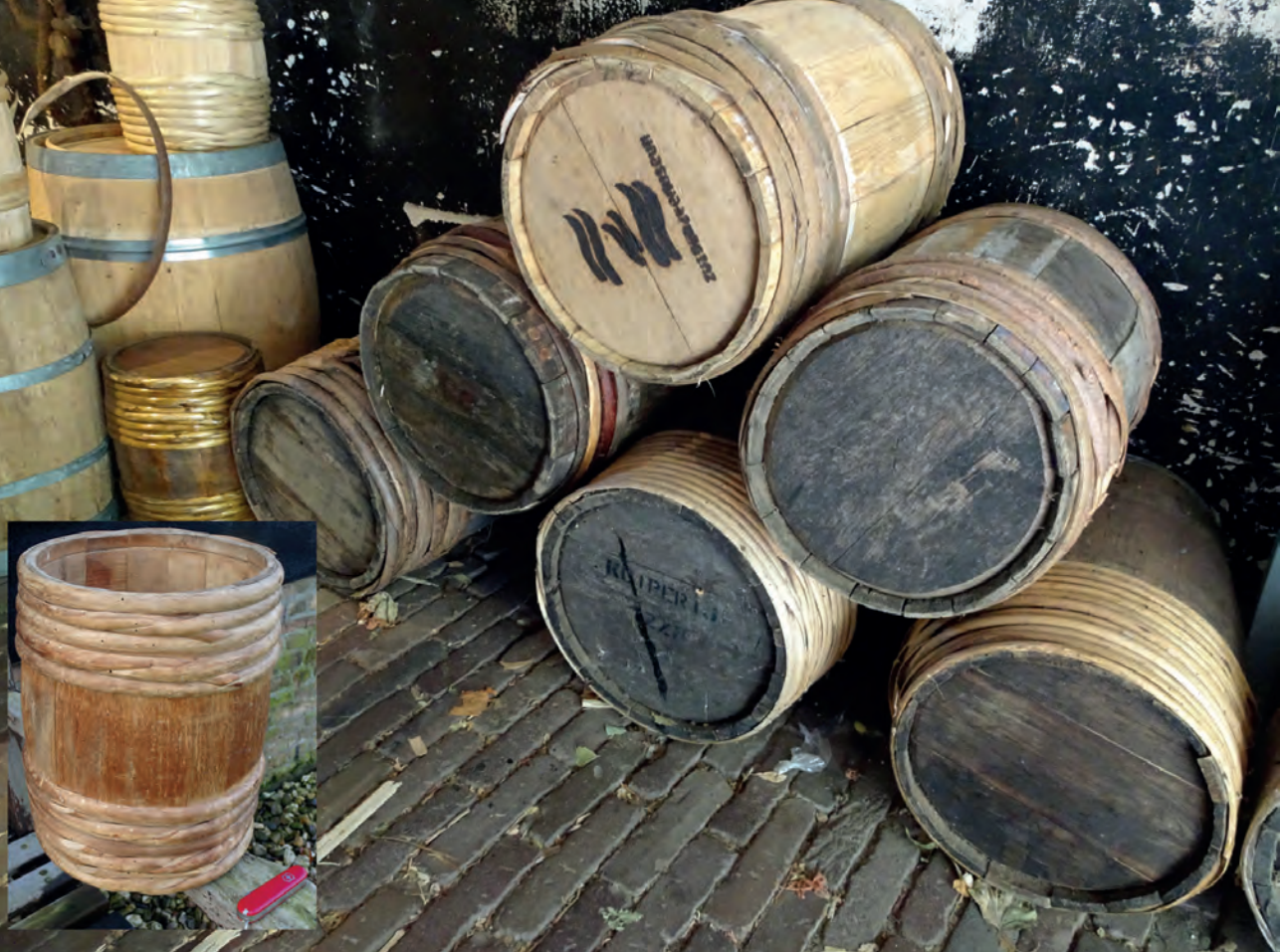
Fig. 7. Het eindproduct: tonnen en vaten met hoepels van wilgenhout die de kuiper van het Zuiderzeemuseum in Enkhuizen gemonteerd heeft. Helemaal van hout gemaakt, er zijn er over een periode van 5 eeuwen miljoenen van gemaakt. Links in beeld tonnen met ijzeren hoepels. Na 1945 in productie gekomen, goedkoper en duurzamer dan de klassieke houten hoepels werd dit het einde van de (oud-)Hollandse hoepelmakerij.
