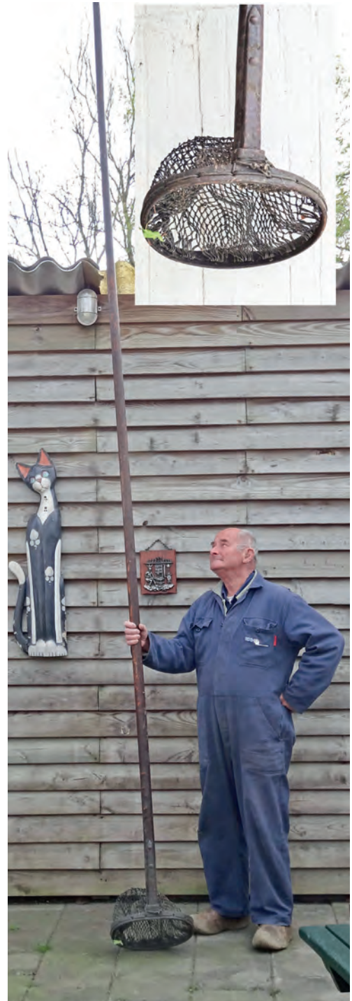
Fig. 5. De baggerbeugel. Om de 3 jaar, als de griend gehakt was, werd met deze beugel de modder uit de sloten rond de grienden gehaald en tussen de stoven verspreid. Dat was een zware klus die enkele weken duurde. De essenhouten stok heeft een lengte van 3,75 meter, het baggernet van hennep touw (inzet) heeft een volume van ongeveer 10 liter.
