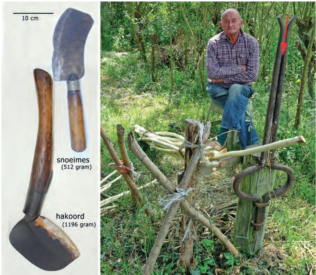
Fig. 3. De griendwerker (Aart Horden) en zijn gereedschap: hakoord, snoeimes en schilijzer. Hakoord (ook wel rijshaak genoemd) en snoeimes waren door de lokale smid gemaakt, werden eens in de 2 jaar door hem op een natte zandsteen vlijmscherp geslepen. Met het hakoord werden met één of twee slagen onderhands takken van griendwilgen geslagen. Met het snoeimes sloeg men (met een enkele slag) van die takken hoepelstokken op de gewenste maat. Iedere griendwerker had zijn eigen hakoord en snoeimes en die gingen een leven lang mee. Het schilijzer (schilklem) werd in mei gebruikt om hoepelstokken te schillen. Die hadden \pm 6 weken in het water gestaan en er waren al weer bladeren, zijtakjes en kleine wortels aan gekomen. De hoepelstok werd van boven in het schilijzer geslagen (rode pijl) en klem tussen de 2 stangen heen en weer gehaald en daarbij een beetje gedraaid. Daardoor kwam de bast in repen los van de stok en die kan dan met de hand verwijderd worden. Per dag werden honderden stokken geschild. Dit schilwerk was erg zwaar en dit ijzer had niet voor niets de bijnaam 'moordenaar' of 'martelpaal'.
